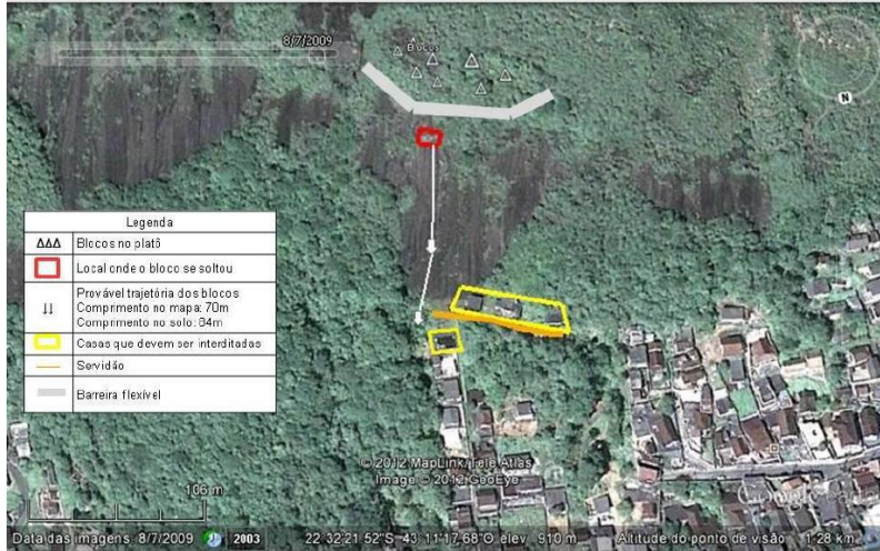
Figura 5: Localização dos blocos e lascas existentes na encosta e das casas que devem ser interditadas.
